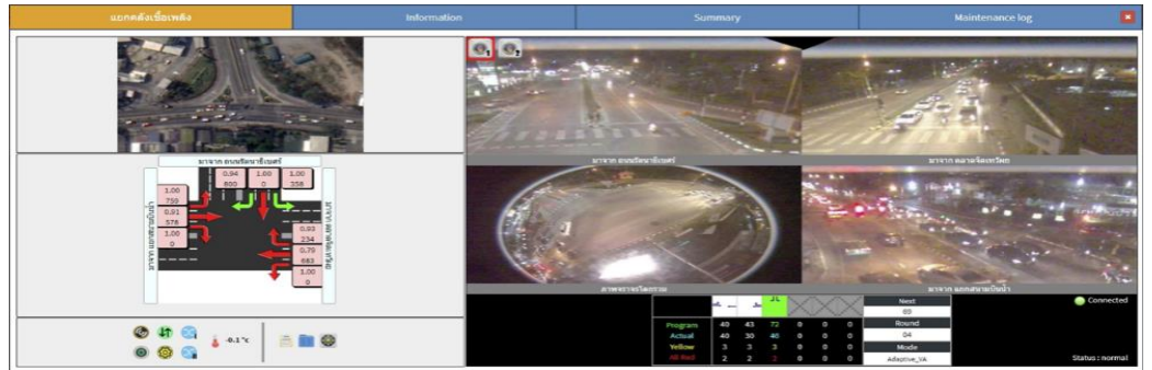
ระบบควบคุมสัญญาณไฟจราจรอัจฉริยะ(Adaptive Intersection Control)
